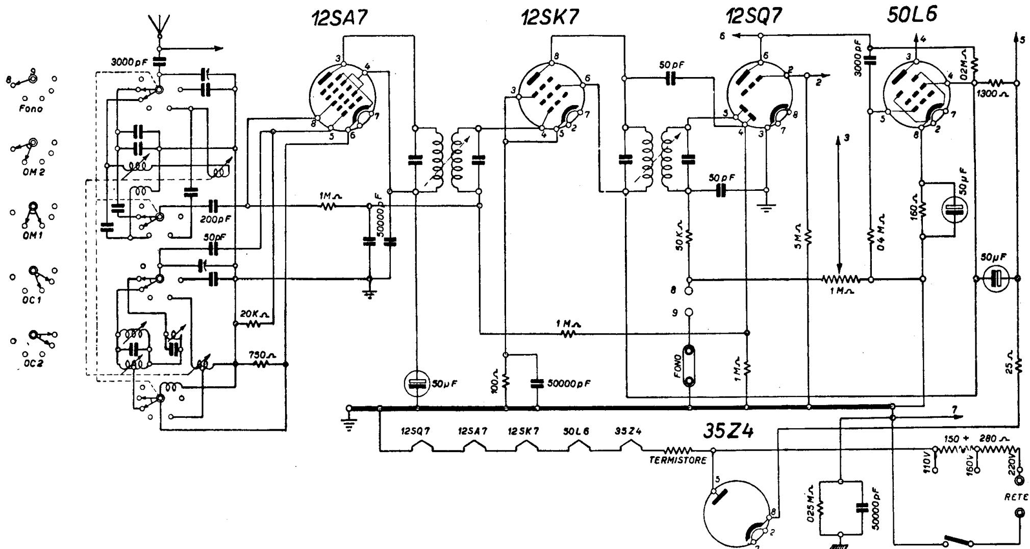
REOM - Sintomagic Radio mod. a10 - Gamma onde medie divisa e due bande onde corte. Notare che nello schema non è indicato l'altoparlante, il quale è invece presente nell'apparecchio multivox, riportato a parte. La caratteristica di questo modello è di funzionare da interfono, consentendo conversazioni bilaterali ad alta voce, nonché riproduzione dei programmi radio in altro ambiente.
